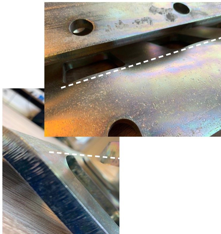
Figuur 1: Vervorming (uitstelping) die ontstaan is na het zetten van het product. Lang de stippellijnen zie je de uitstelpingen ontstaan.
